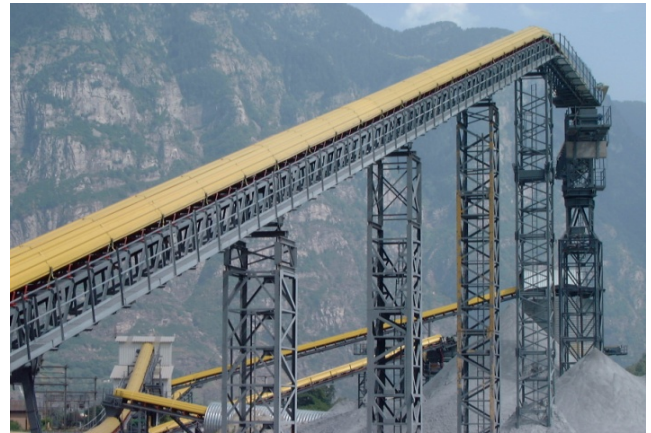
Nastro trasportatore a deposito intermedio
