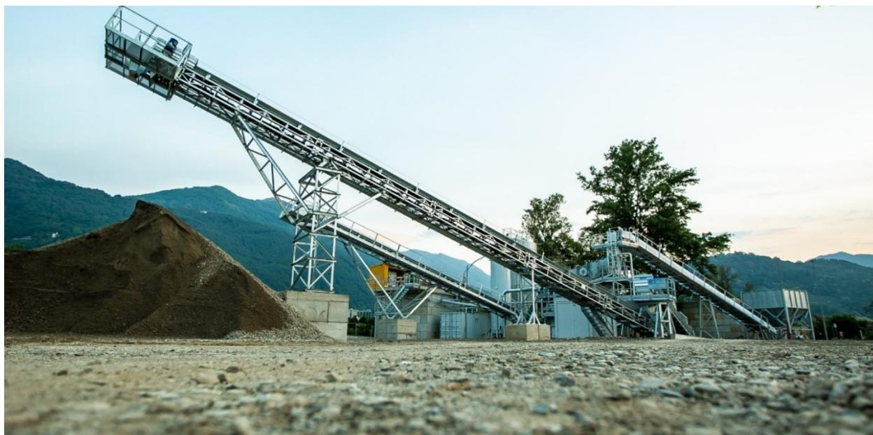
Impianto fisso per selezione, lavaggio e produzione di misti granulari certificati
