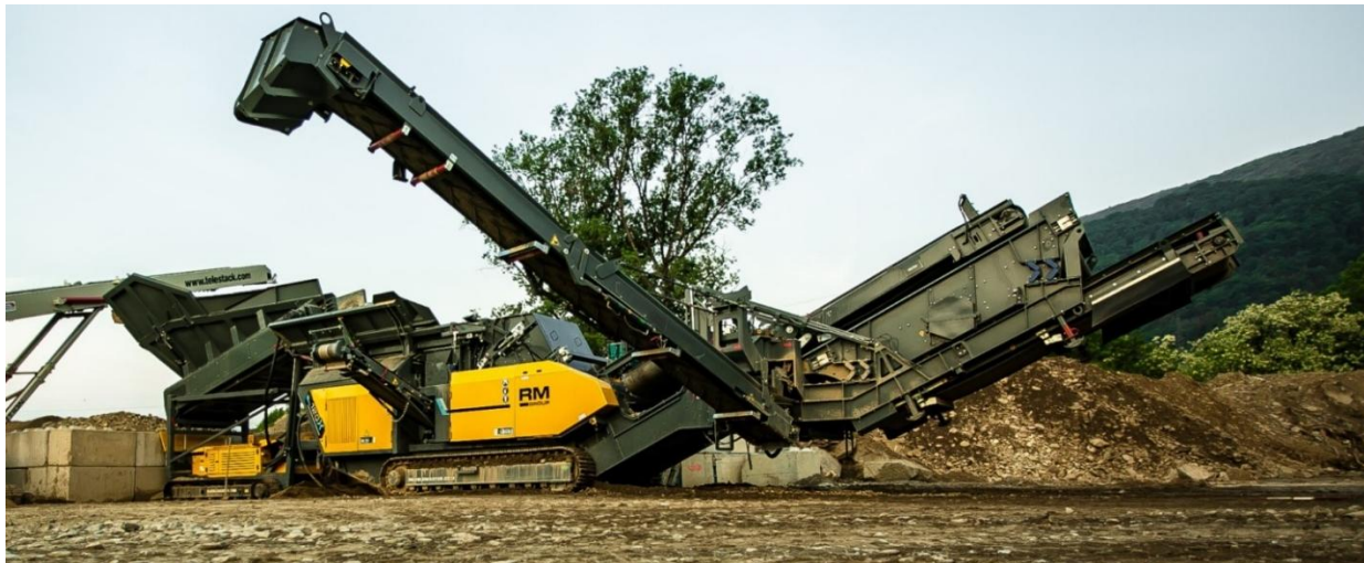
Impianto mobile per la pre-frantumazione dei materiali di scavo
