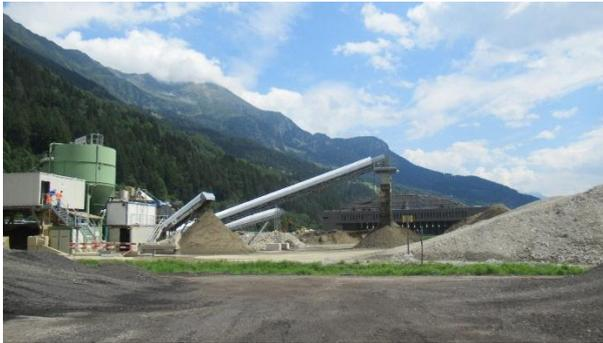
Impianto di lavorazione di misto granulare 0/45 con lavaggio
